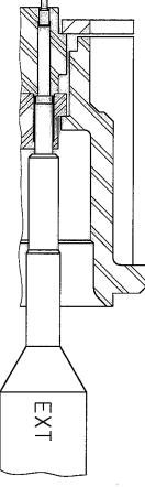
2/TAKE THE CONTACT OUT OF THE CAVITY BY PULLING BACK THE TOOL TAKE THE CONTACT OUT OF THE TOOL
