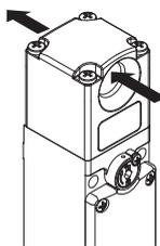
L'interruttore è dotato di un foro passante per l'inserimento dell'azionatore e grazie a questa particolarità l'eventuale sporcizia che dovesse entrare nel foro dell'azionatore ha sempre la possibilità di uscire dalla parte opposta, anziché fermarsi al suo interno. Inoltre il perno di blocco è dotato di una guarnizione a membrana esterna che lo rende adatto all'utilizzo in ambienti con presenza di polvere.
