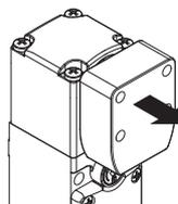
**9750 N** Il robusto sistema di interblocco garantisce una forza di ritenuta massima dell'azionatore  $F_{1max}$  pari a 9750 N. Questo valore è uno dei più elevati presenti oggi sul mercato e rende il dispositivo adatto per applicazioni molto gravose.
