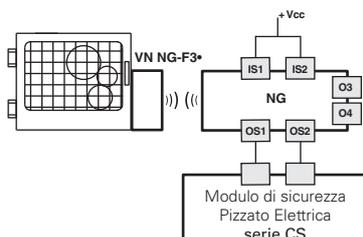
L'interruttore serie NG può essere usato singolarmente, previa valutazione delle uscite sicure da parte di un modulo di sicurezza Pizzato Elettrica (vedi tabella moduli di sicurezza abbinabili).
