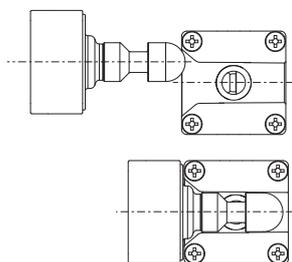
L'interruttore è dotato di un ampio imbocco di centraggio per il perno dell'azionatore. Tale soluzione rende più facile l'allineamento tra l'azionatore ed il foro presente nella testa durante la fase di montaggio. Inoltre questa soluzione riduce drasticamente le probabilità di collisione tra l'azionatore e l'interruttore, permettendo la sua installazione anche su porte non precise.
