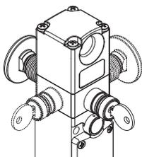
Il dispositivo di sblocco a serratura (auxiliary release) permette lo sblocco dell'azionatore solo al personale in possesso della chiave di azionamento. Funziona anche in assenza di alimentazione ed una volta azionato impedisce il blocco della protezione.
