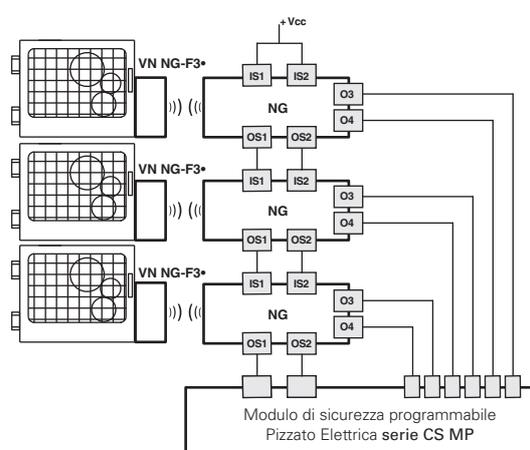
Possibilità di collegamento in serie di più interruttori per semplificare il cablaggio del sistema di sicurezza previa valutazione delle uscite dell'ultimo interruttore della catena da parte di un modulo di sicurezza Pizzato Elettrica della serie CS MP, che permette la gestione sia della parte di sicurezza sia della parte di segnalazione. Gli esempi sopra riportati si riferiscono ad applicazioni con NG 2●●●●●●.
