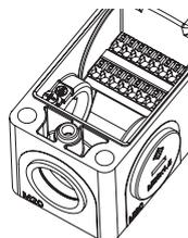
L'interruttore al suo interno è dotato di un sistema di connessione a molla tipo PUSH-IN. Questa tecnologia consente un cablaggio pratico e veloce, poiché è richiesto il semplice inserimento del filo nell'apposito foro per ancorarlo e stabilire il collegamento elettrico. Tale operazione potrà essere eseguita senza l'ausilio di alcun utensile impiegando fili rigidi o flessibili con puntalino. Lo sgancio avviene invece premendo l'apposito pulsante di rilascio del filo.
