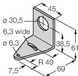
Монтажный кронштейн, прямоугольный, нерж. сталь, для датчиков с резьбой 30 мм
