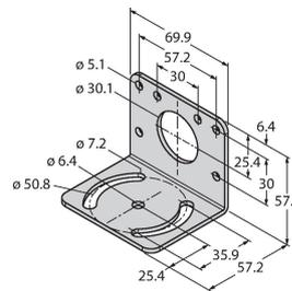
Монтажный зажим, нерж. сталь, для датчиков с резьбой 30 мм
