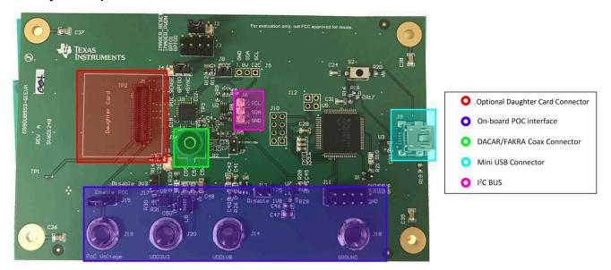
Figure 2-2. DS90UB95x-Q1EVM Major Components
