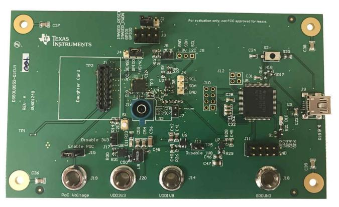
Figure 1-1. DS90UB95x-Q1EVM Top View
