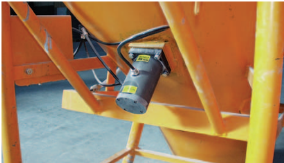
Austragshilfe am Behälter
