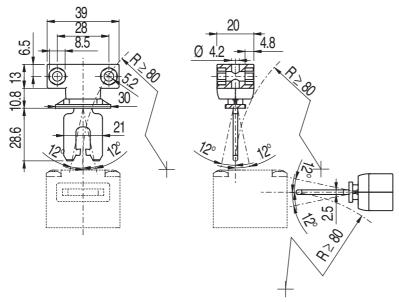
Figure 14.4: AC-AHL-F4J2-TK actuator
