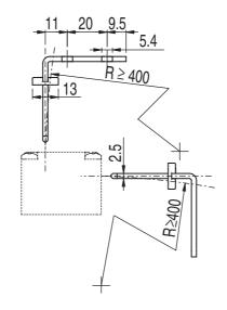
Figure 14.2: AC-AHL-A actuator
