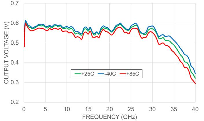
OUTPUT VOLTAGE vs. FREQUENCY OVER TEMPERATURE RANGE @ INPUT POWER 0dBm
