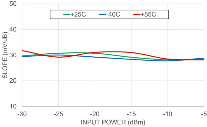
SLOPE Vs INPUT POWER OVER TEMPERATURE RANGE
