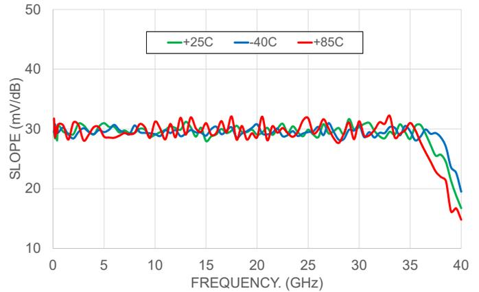
SLOPE Vs FREQUENCY OVER TEMPERATURE RANGE
