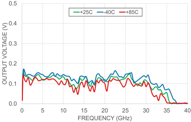
OUTPUT VOLTAGE vs. FREQUENCY OVER TEMPERATURE RANGE @ INPUT POWER -20dBm
